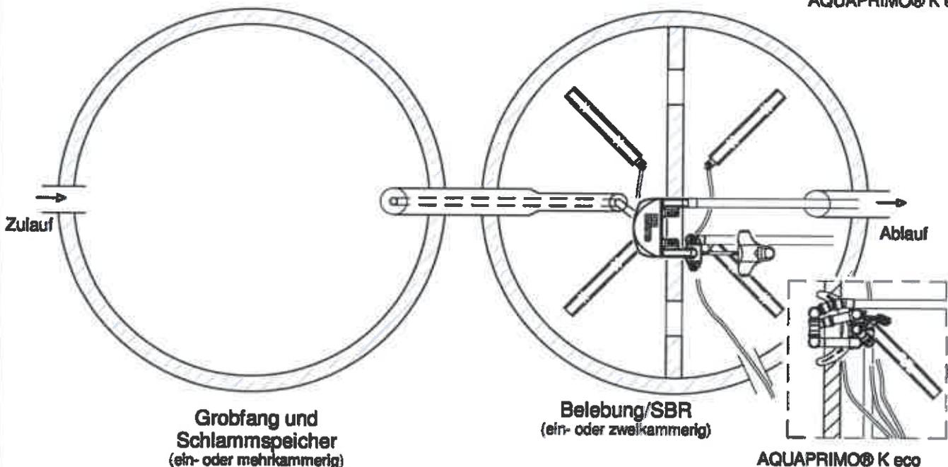
Kleinkläranlagen mit Abwasserbelüftung; Belebungsanlagen im Aufstaubetrieb;
