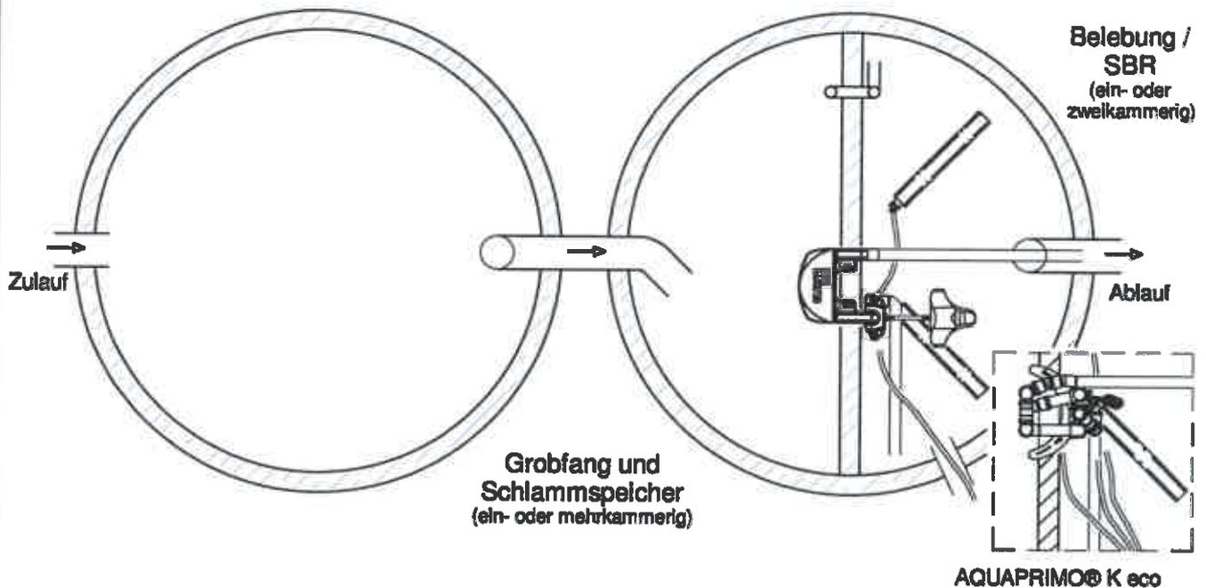
Kleinkläranlagen mit Abwasserbelüftung; Belebungsanlagen im Aufstauetrieb;
