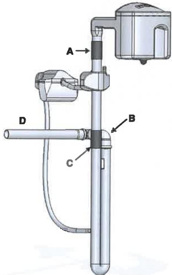
Die Überlaufschikane wird vormontiert geliefert und ist im Behälter zusammenzusetzen.
